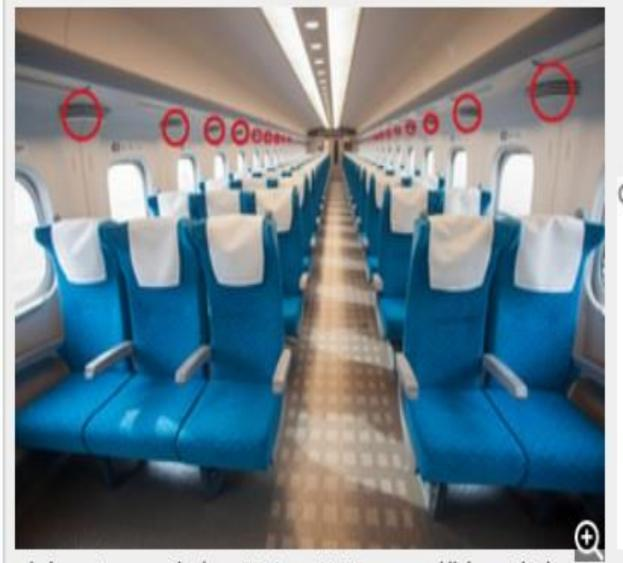
○新幹線の車内では、空間・換気装置により、常に外の空気との入れ替えを 行うなど、快適な環境をご提供するよう努めています。
